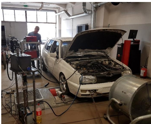
1 pav. Variklio energetinių rodiklių matavimas naudojant lengvųjų automobilių traukos stendą „CARTEC LPS 2510“
