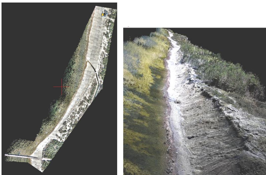
2 pav. Aerokartografavimo produktai, taikant UAV-Fotogrametrija technologiją: Baltijos jūros pakrantės (ties Palangos miestu) ortofotografinė nuotrauka ir skaitmeninio 3D modelio fragmentas
