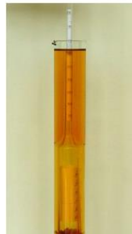
3 pav. Tankio nustatymas prietaisais: a - areometrų rinkinys, b -areometras
