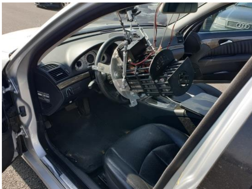
10 pav. Eksperimentinio tyrimo metu naudotas vairo sukimo robotas
