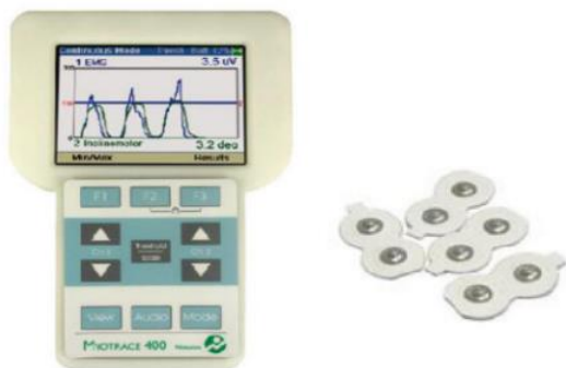
2 pav. Elektromiografas Myo Trace 400 ir paviršiniai elektrodai Šaltinis: sudaryta autorių
