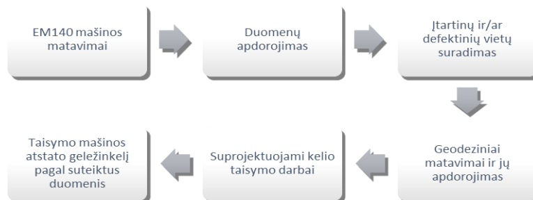
3 pav. Geležinkelio priežiūros darbų etapai kelio būklei nustatyti Šaltinis: sudaryta autorių
