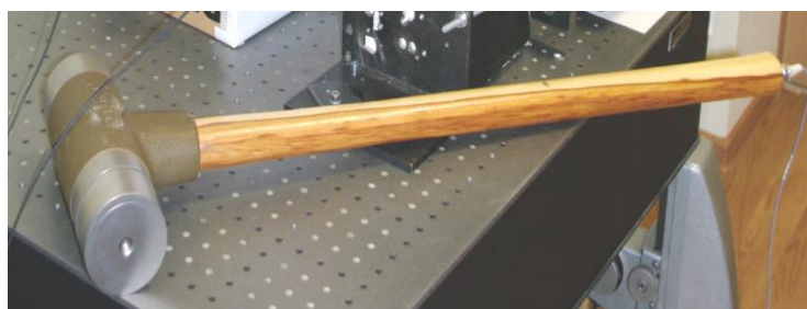
4 pav. Vertikalių smūginių virpesių sukūrimui naudojama priemonė
