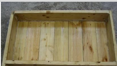
2 pav. Pertekliniu tepalo kiekio padengtos formos vaizdas (a), iš formos išimto betono bandinio paviršiaus vaizdas (b) ir formos, išėmus bandinį, paviršiaus vaizdas (c)
