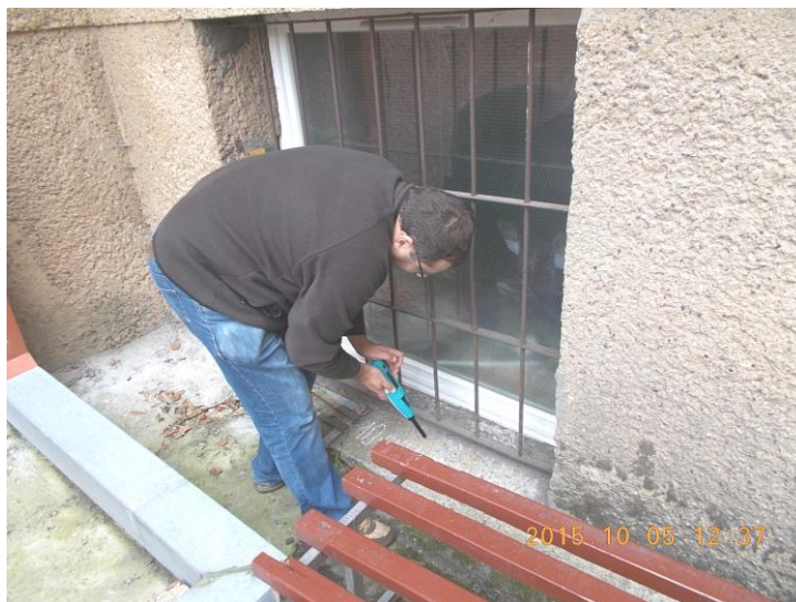
2 pav. Betono gniuždomojo stiprio nustatymo neardančiuoju metodu iliustracija
