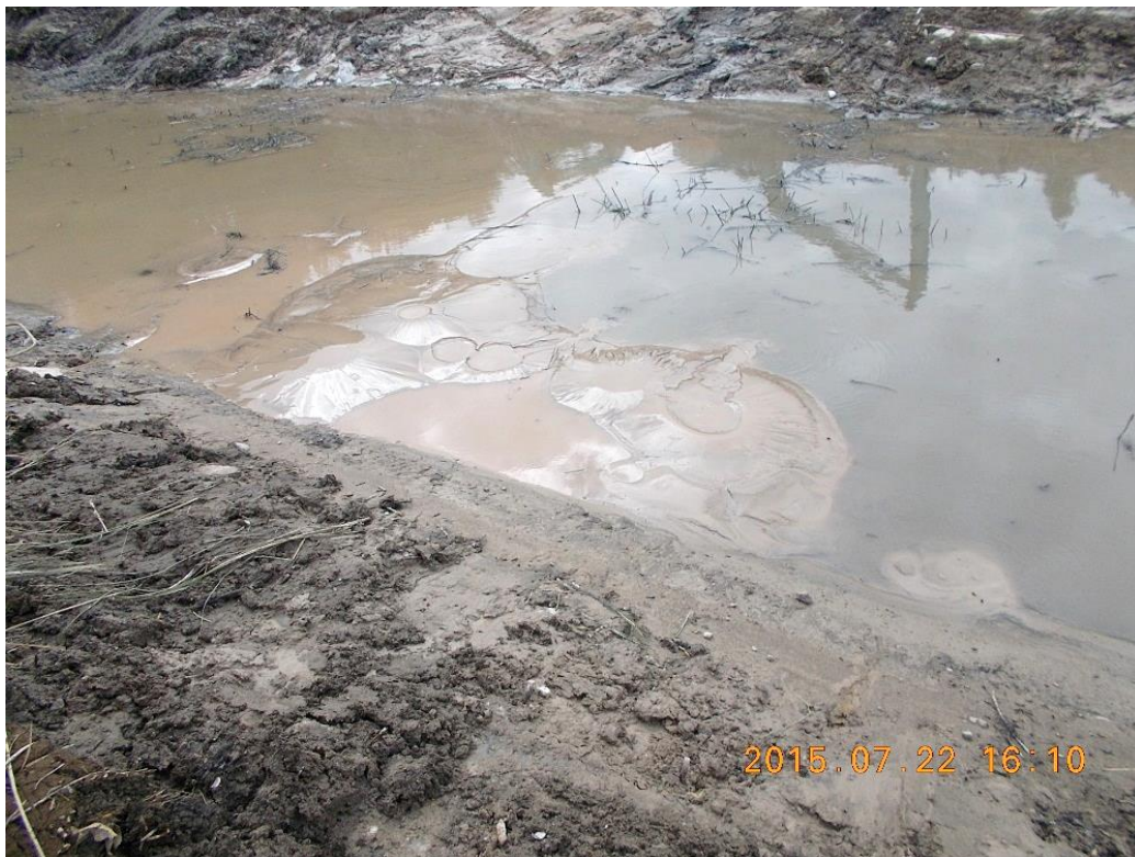
1 pav. Geofiltracijos išsikrovimo taškai užtvankos risbermos dugne
