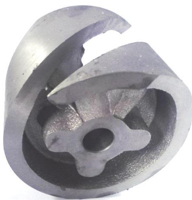
2 pav. Mechanškai apdirbtas erdvinis kumštelis
