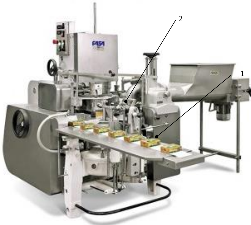
4 pav. ARM automatinė mašina: 1 – stalas, 2 – erdvinis kumštelis
