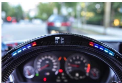
4 pav. Vaire integruota sūkių atvaizdavimo sistema
