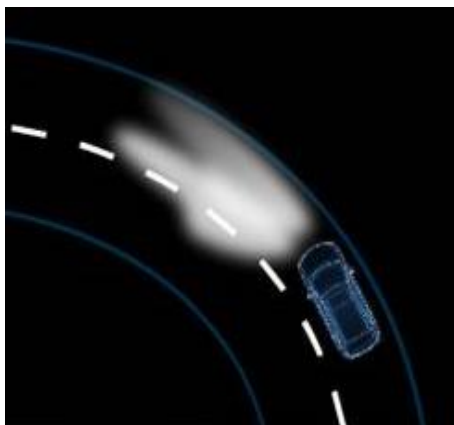
5 pav. Sistemos veikimas važiuojant kelio vingiu
