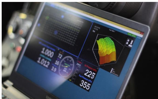
1 pav. Variklio valdymo bloko programavimas
