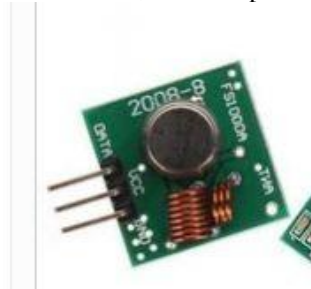
10 pav. 433MHz dažnio ASK radijo modulis [21]
