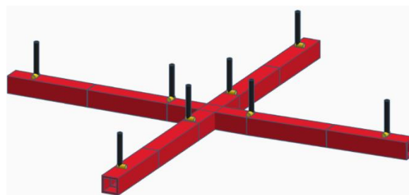
6 pav. RF siųstuvo pozicijos detektoriaus antenų išdėstymas
