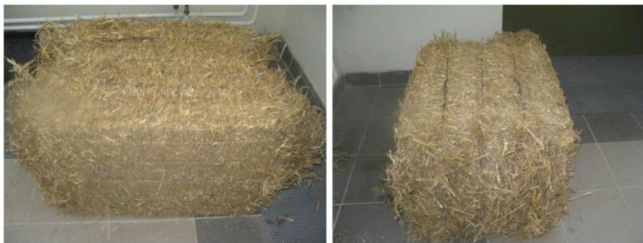
1 pav. Stipriai supresuoti šiaudai, kurių tankis apie 400 kg/m 3
