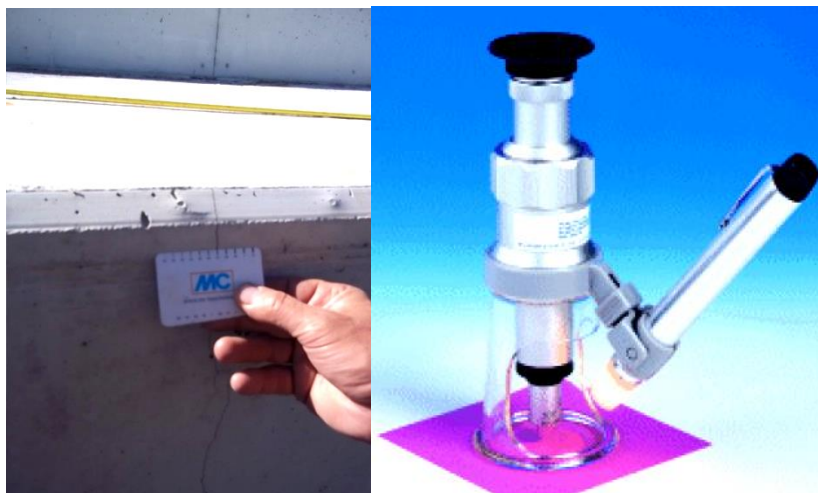
1 pav. Plyšių pločio matavimo iliustracija naudojant plyšių pločio fiksavimo liniuotę ir mikroskopą Šaltinis: sudaryta autorių
