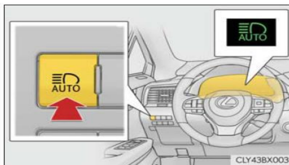
3 pav. Lexus RX 2020 automatinės automobilio žibintų valdymo sistemos šviesos atskiras jungiklis ir būsenos indikacija
