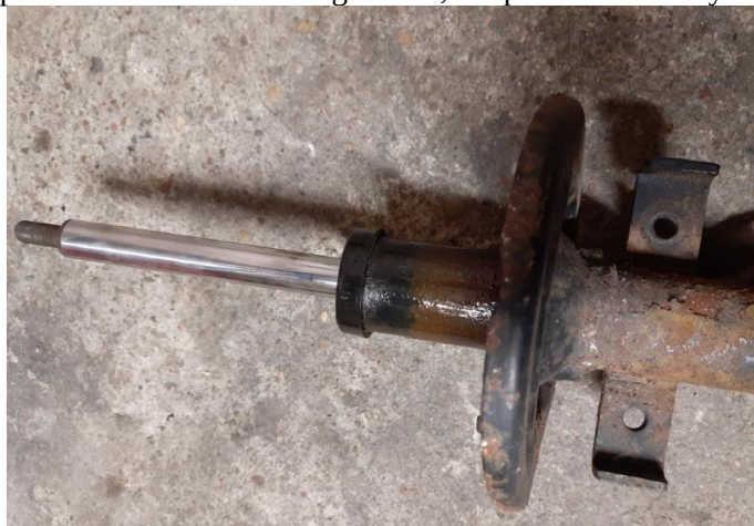
4 pav. Amortizatoriaus gedimas, kai prasiskverbia alyva
