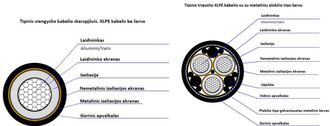
1 pav. Tipinis vidutinės įtampos kabelių skerspjūviai
