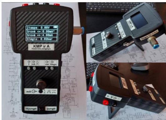
18 pav. Daigiafunkcinio testavimo įrenginio prototipas: 1 – srovės kilpos matavimo jungtys, 2 – srovės kilpos išėjimo jungtys, 3 – įtampos matavimo jungtys, 4 – slėgio jutiklis, 5 – OLED ekranas, 6, 7, 8, 9– mygtukai, 10 – akumuliatoriaus baterijos įkrovimo pabaigos indikatorius, 11 – akumuliatoriaus baterijos įkrovimo indikatorius, 12 – skaitmeninis potenciomtras, 13 – įjungimo – išjungimo mygtukas, 14 – akumuliatoriaus baterijos įkrovimo lizdas.
