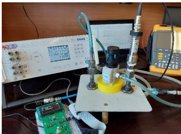
16 pav. Suspausto oro slėgio matavimas testuojamu įrenginiu, veikiant stendo slėgio jutiklį
