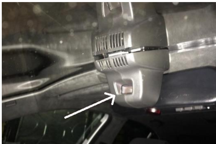
1 pav. BMW 5 E60 2007 automatinės AŽV sistemos šviesos jutiklio įrengimo vieta (parodyta rodykle)
