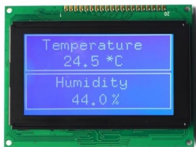
9 pav. a) LCD ekrano struktūra, b) LCD tipo grafinis ekranas [6]
