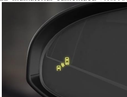
1 pav. Aklosios zonos stebėjimo sistemos vaizdinis indikatorius „TOYOTA CAMRY 2016“
