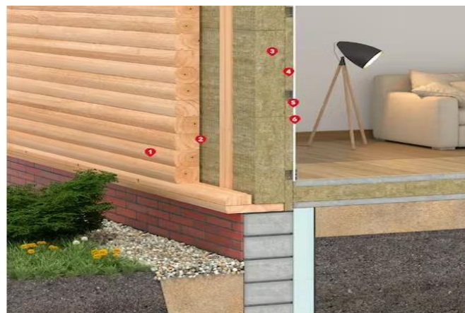
4 pav. Rąstinės sienos apšiltinimas iš vidaus: 1- rąstų siena; 2- oro tarpas; 3- Superrock Premium akmens vata; 4- Superrock Premium akmens vata; 5- garo izoliacinė plėvelė; 6- gipso kartono plokštė ir vidaus apdaila Šaltinis: Rąstinio namo šiltinimas iš vidaus. https://www.rockwool.com/lt/gaminiai-ir-panaudojimas/fasadu-izoliacija/vedinamu-fasadu-siltinimas/rastinio-namo-siltinimas-is-vidaus/
