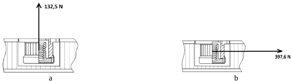
10 pav. Srieginės įvorės patikra: a) Jėga raunanti srieginę įvorę; b) Jėga apkraunanti srieginę įvorę glemžimui
