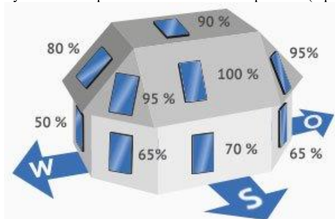
7 pav. Saulės elementų išdėstymo efektyvumo schema (www.estsolar.lt)
