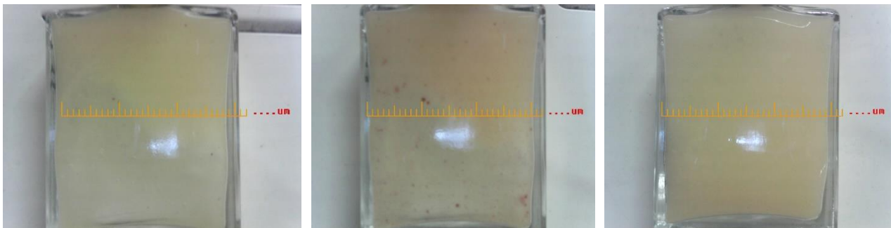
6 pav. Ilgą laiką saugoto dyzelino su biodyzelino priedu (D3) mėginys: A – po 2 mikrobiologinio užterštumo tyrimo parų, B – po 3 mikrobiologinio užterštumo tyrimo parų, C – be biologinio užterštumo Šaltinis: sudaryta autorių
