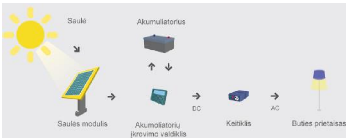
2 pav. Autonominės saulės elektrinės schema (www.sauleselektrines.lt)
