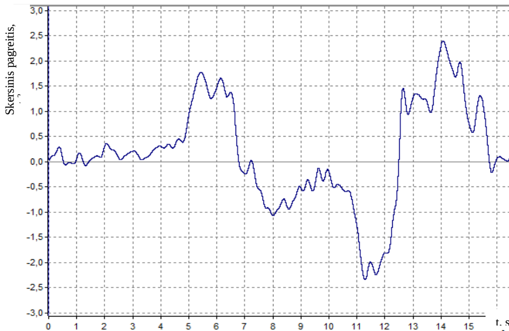
4 pav. Tuščio automobilio su barstytuvu skersinių svyravimų pagreičių priklausomybė nuo laiko (važiuojant 50 km/h greičiu)
