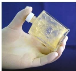
2 pav. Degalų testavimas su MIKROCOUNT rinkiniu
