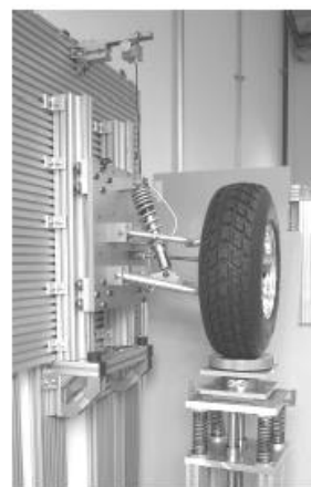
6 pav. Miuncheno universiteto ketvirčio automobilio bandymo stendas Šaltinis: (Koch et al., 2010)
