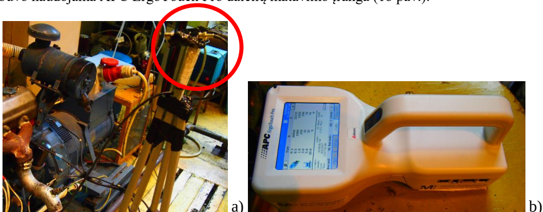
1 pav. Variklio garso slėgio matavimo stendas
