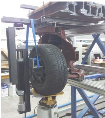
3 pav. Prahos technikos universiteto automobilio pakabos bandymo stendas Šaltinis: (Hyniova et al., 2016)
