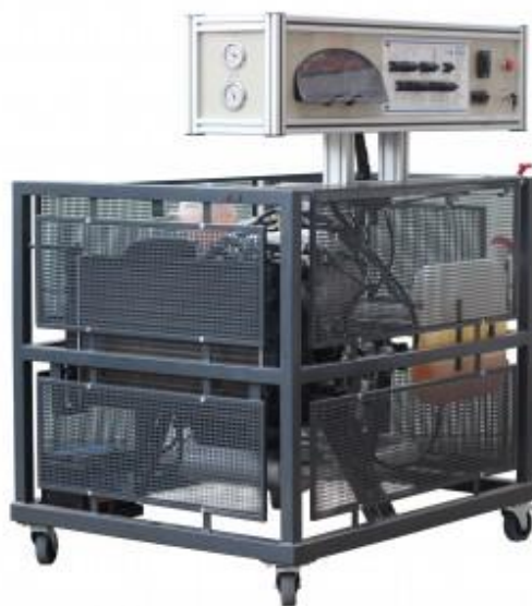
3 pav. Mokomasis veikiantis variklis su benzino įpurškimo sistema MOTRONIC
