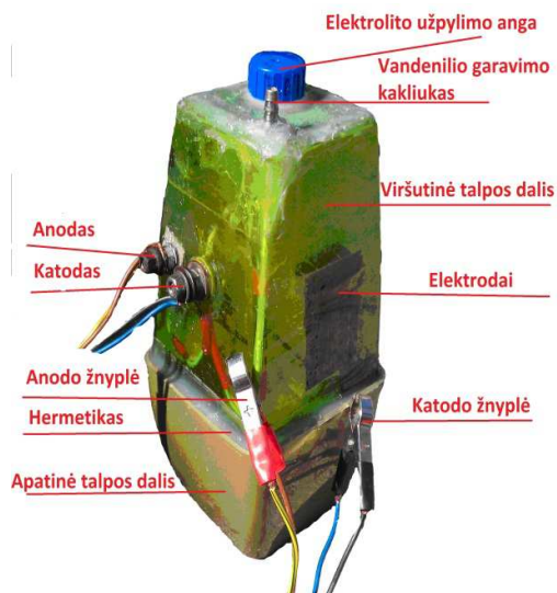
5 pav. Brauno dujų generatorius - elektrolizeris Šaltinis: sudaryta autorių
