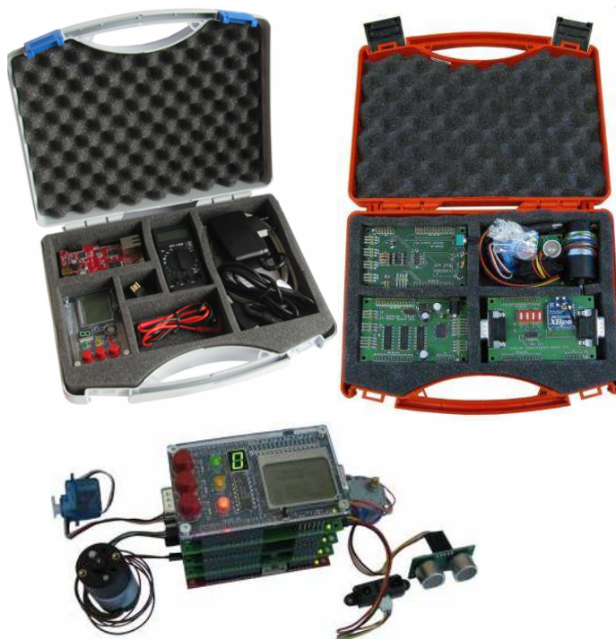
2 pav. Robotic HomeLab Basic ir Add-On rinkiniai, intelektualios kameros modulis (CMUcam3)
