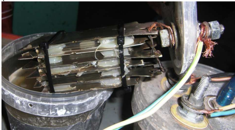
2 pav. Sukonstruoto aparato elektrodų bendras vaizdas Šaltinis: sudaryta autorių
