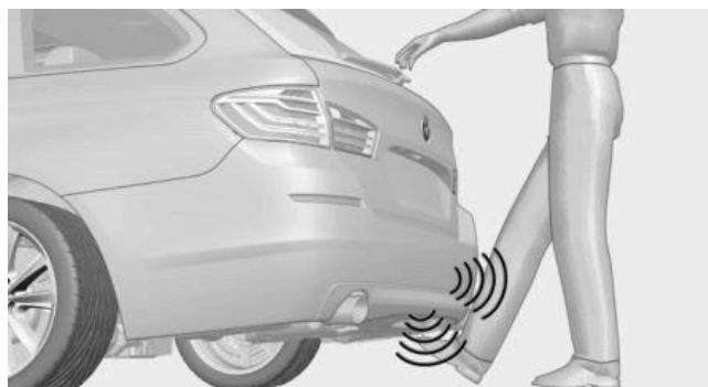
1 pav. BMW automobilio bagažinės atidarymo kojos judesiu sistemos kojos judesio aptikimas Šaltinis: (BMW Owner's Manual 2020: 76 - 102)
