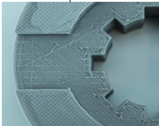
6 pav. 3D atspausdinta detalė. Greitis 40 mm/s, sluoksnio storis 0,15 mm.
