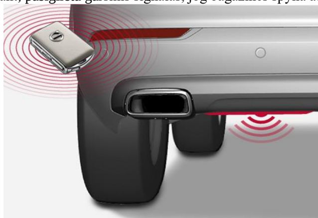
1 pav. Volvo automobilio bagažinės atidarymo kojos judesiu sistemos jutiklių išdėstymas Šaltinis: (Volvo Owner's Manual 2018: 267 - 271)
