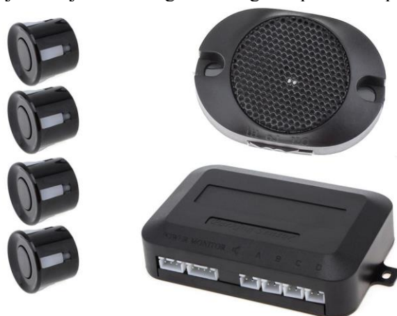
1 pav. Parkavimo sistema su 4 judesio jutikliais ir garsiniu signalu Šaltinis: (HY Technologies, 2019)
