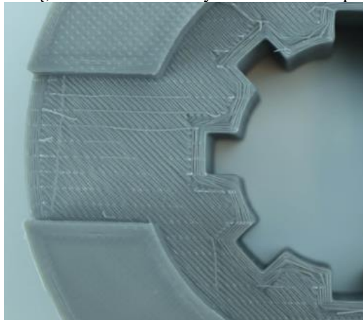
8 pav. 3D atspausdinta detalė. Greitis 80 mm/s, sluoksnio storis 0,15 mm.
