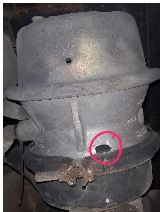
4 pav. Įskilęs energoakumuliatoriaus korpusas
