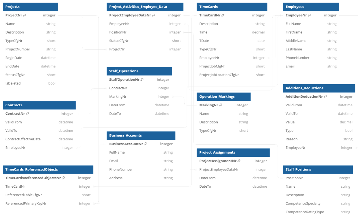
6 pav. Projektų žmogiškųjų išteklių darbo laiko apskaitos sistemos naudojamos duomenų bazės lentelės
